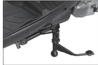
Der Seitenständer wird mit dem Fuß bis zum Anschlag herausgeklappt.
