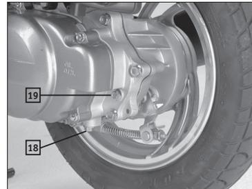
5. Ziehen Sie anschließend die Schraube wieder fest an und lösen Sie die Schraube **19**.
